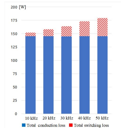
그림 11 Hybrid ANPC 인버터의 정방향 운전 시 스위칭 주파수별 전력 손실 Fig. 11 Power loss of Hybrid ANPC inverter under different switching frequency (PF: 1)
