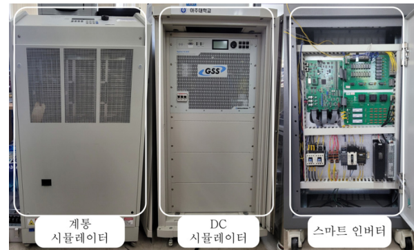
그림 8 제안하는 Volt-VAR 및 Volt-Watt 결합 제어의 검증을 위한 실험 환경 Fig. 8 Experimental set-up to verify the proposed combined Volt-VAR and Volt-Watt control
