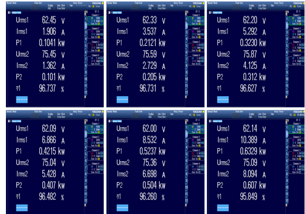
그림 10 전력 공급 컨버터 부하 성능 실험 결과 Fig. 10 Power converter load performance test results
